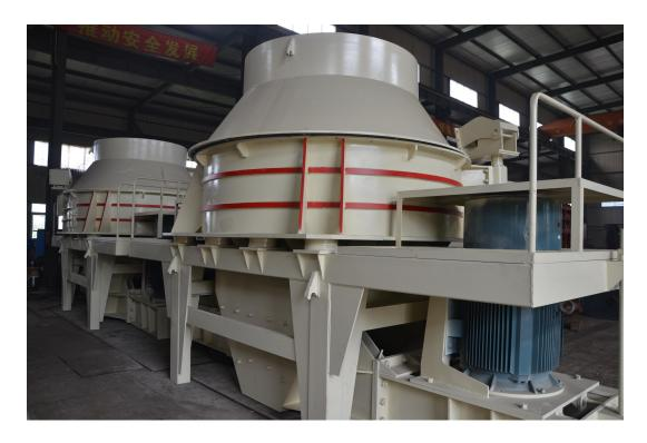
◆ 高效制砂机是引进吸收德国BHS公司技术基础上进一步吸取立式冲击破的优点并加以改进,同时综合了锤式、反击式细碎机的长处而综合开发研制成功的最新一代高效复合式制砂机,其性能在各种矿石细碎设备中起着不可替代的作用。高效制砂机设备可广泛应用于金属和非金属矿石、建筑材料、人工造砂以及各种冶金矿渣的破碎与整形。本机适用于莫氏硬度小于9级的脆性物料,不适用于粘性物料以及含泥土较多的石料。
