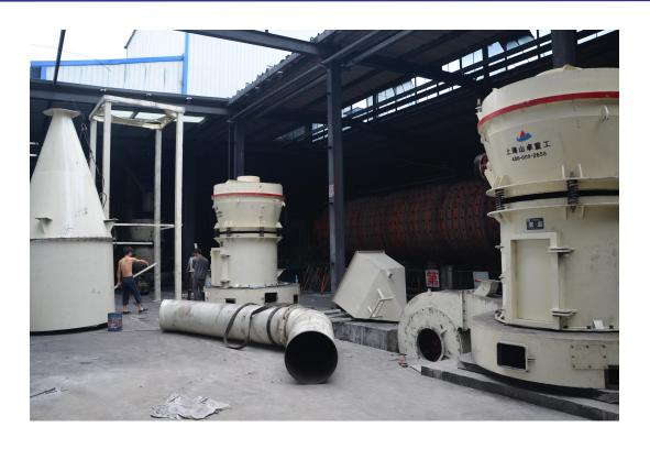
◆ 高压磨粉机广泛应用于矿山、冶金、化工、建材等行业280多种物料的高细制粉加工,适用于研磨莫氏硬度不大于9.3级,湿度在6%以下的非易燃易爆的物料。如石英、长石、方解石、石灰石等物料,其主要组成设备有主机、减速机、分析机、管道装置、鼓风机、除尘器、颚式破碎机、畚斗提升机、电磁振动给料机、电控系统等。
